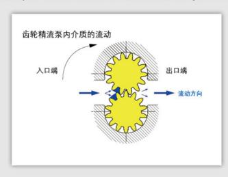
齿轮精流泵结构简单(只有两个运动部件、无单向阀等易出现故障的附件)、计量精确 流量均匀无脉动。在从稀薄的到粘稠的流体计量中有着极其广泛的应用。在以往,这一点经 常被忽视。现在,在要求更长的使用寿命和更高精度的场合,齿轮精流泵已经有了大量的 OEM 应用。传统上人们通常选用隔膜式和柱塞式精流泵来达到计量要求。其实,齿轮精流泵 在满足终端用户的计量要求时的表现,也相当出色——它可能是精流泵家族中更优秀的一员。
